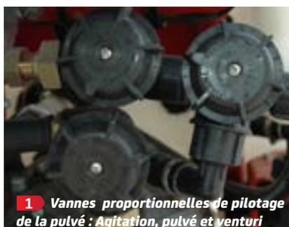
1 Vannes proportionnelles de pilotage de la pulvé : Agitation, pulvé et venturi
