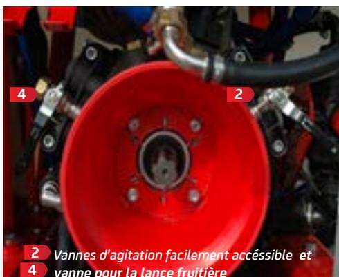
2 Vannes d'agitation facilement accessible et
