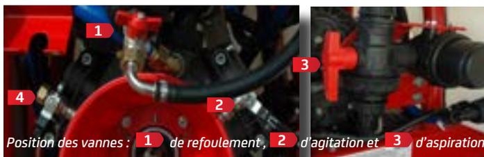
Position des vannes : 1 de refoulement, 2 d'agitation et 3 d'aspiration
