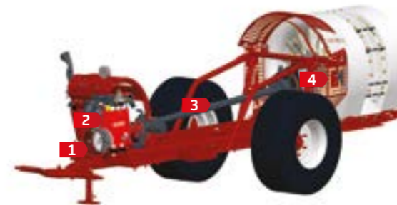
Partie arrière du châssis basculable pour faciliter l'entretien de la ventilation - Châssis ASI
