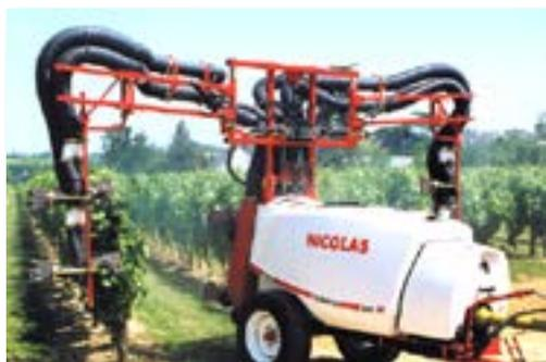
Disponible également, l'option orientation électrique des canons pour encore plus de confort d'utilisation. Les diffuseurs peuvent recevoir l'option TurboDiff.
