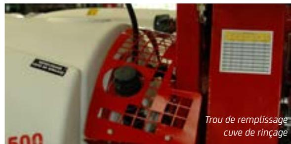
Trou de remplissage cuve de rinçage
