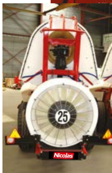
Ventilations, rampes, grilles INOX et Nicojets
