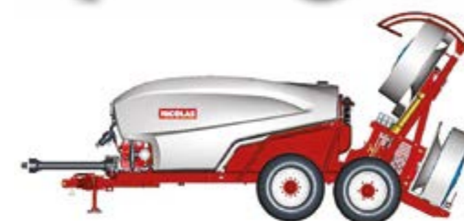
Partie arrière du châssis basculable pour faciliter l'entretien de la ventilation
