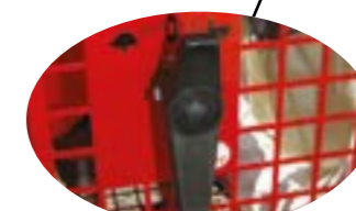
Poignée de réglage de la vitesse : position lièvre ou tortue
