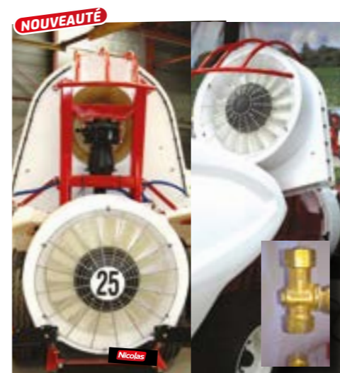
Ventilation basse avec grille de protection en Inox et porte-buses Nicojets orientable à 2 positions volume normal/ volume réduit
