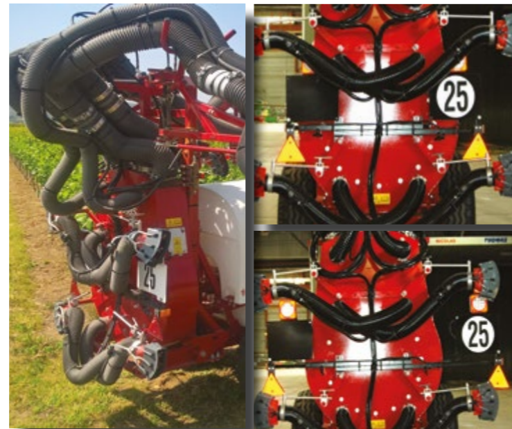
Signalisation routière position travail et route
