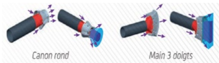
Effet Venturi avec Turbo diffuseurs et orientation électrique des canons
