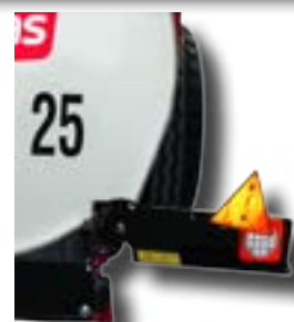
Signalisation routière position travail et route avec emplacement pour la plaque minéralogique
