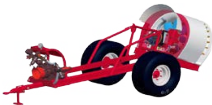
Partie arrière du châssis basculable pour faciliter l'entretien de la ventilation
