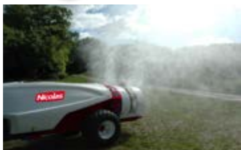
Montage en standard bijet avec buses Albus ATR 80° jaune et vert
