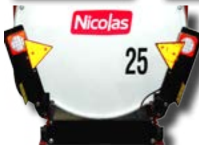
Signalisation routière position travail et route avec emplacement pour la plaque minéralogique
